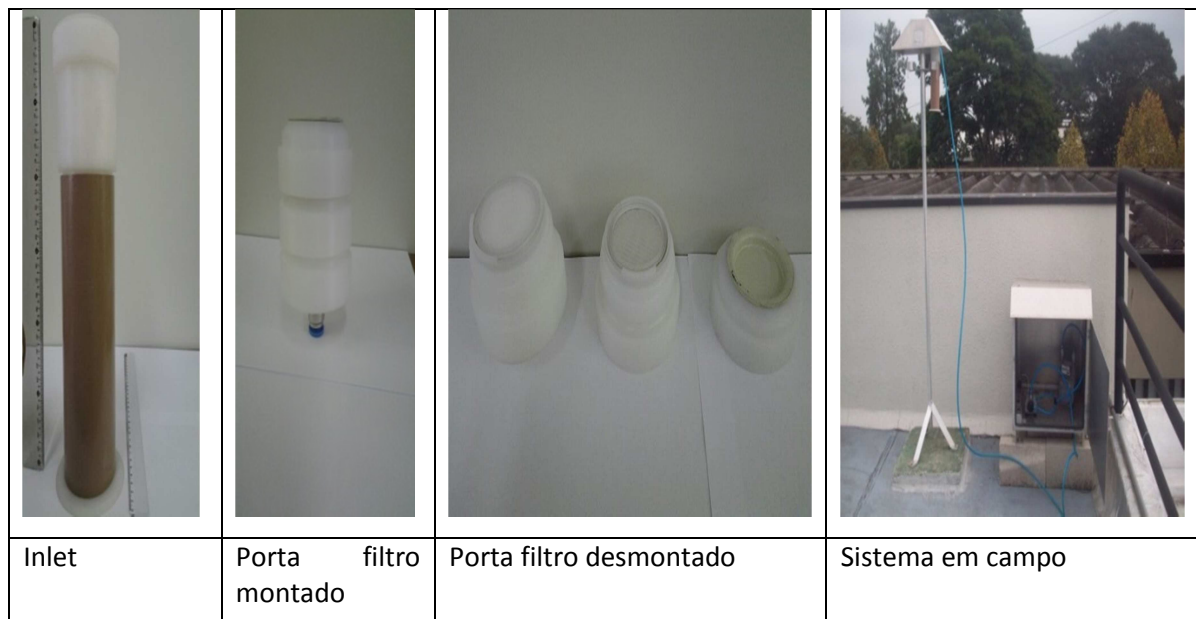
Figura 1. Amostrador AMDic SFU.
