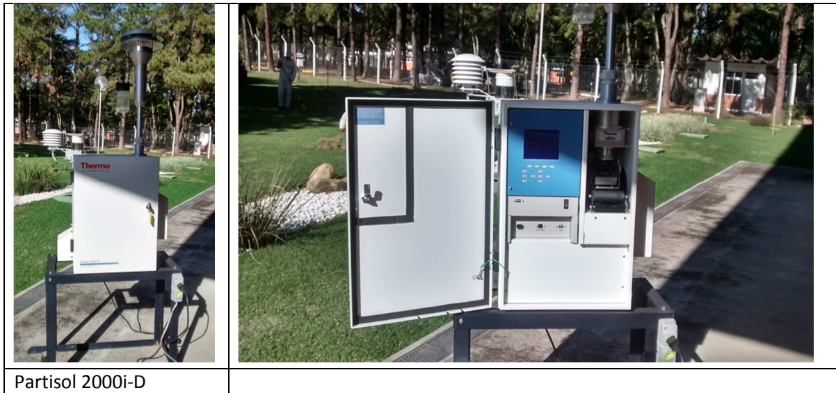
Figura 4. Amostrador Dicotômico Partisol 2000i- D.
