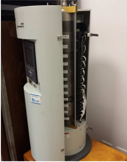
Figura 3. Impactador (Model 125R NanoMoudi-II).
